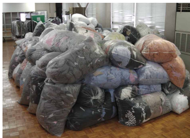
山形工場内にて。これまで産業廃棄物だった裁断くずが防水シートにリサイクルされ、収益を生む素材に。
