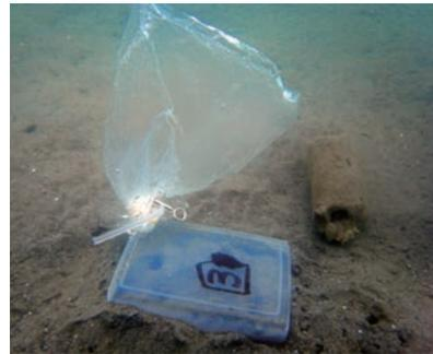
【写真4】湧水量の簡易測定器
