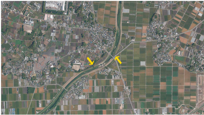
霞堤の例 (矢印の先が開口部)
