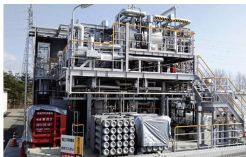
アンモニア合成実証試験装置
