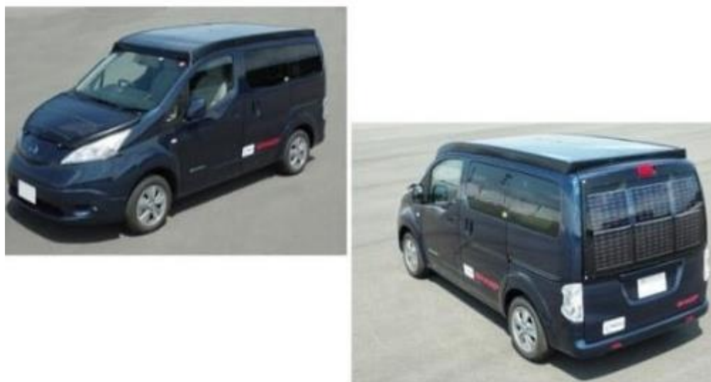
付図 3 太陽電池パネルで 1kW 超級の定格発電電力を実現し、日産自動車の商用 EV「e-NV200」に搭載した（NEDO）
