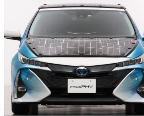
NEDO、シャープ、トヨタは2019年7月、プラグインハイブリッド車プリウスPHVの屋根、フード、後部ハッチドアに効率34%以上の0.03mm厚の太陽電池をとりつけ自立走行する自動車の実験を公開した。
