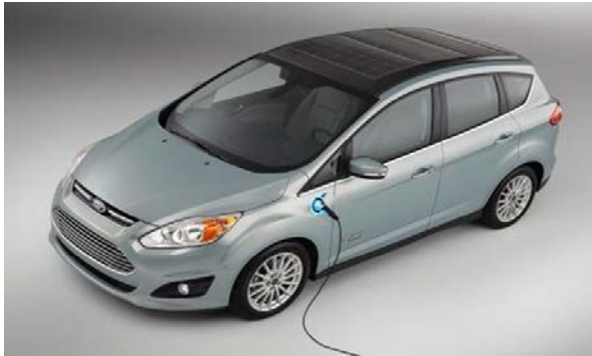
図 A6 フォード社が発表したソーラーパネル搭載の電気自動車（2014 年）
