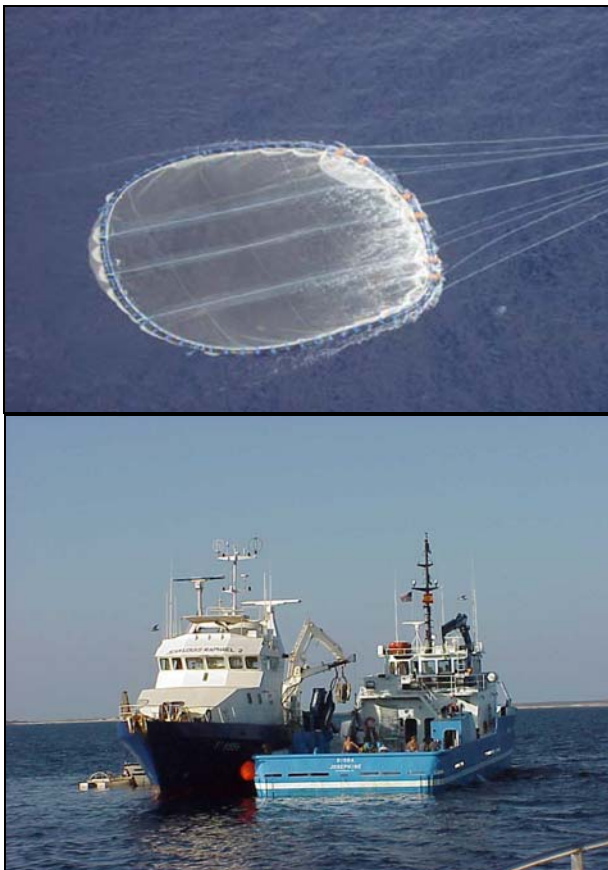
写真 014.- 上: 曳航されている Standard Corelsa ®TM の直径 50m 型曳航用生簀。下: クロマグロ巻網漁船から海水槽船への死亡マグロの洋上積替作業。(写真 ATRT)
