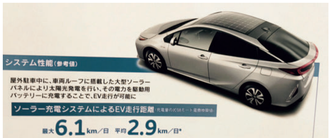
図A-7 トヨタが発表したソーラーパネル搭載のプリウスPHV（2016年）
